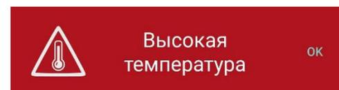
резкий рост давления, что может привести к взрыву колеса) – если нагрев произошел в режиме нормального движения ТС, то необходимо остановиться и выявить причину. Если, нагрев произошел при интенсивном торможении, то необходимо продолжать движение на низкой скорости для снижения нагрузки на шины и охлаждения узла (остановка ТС с перегретым тормозом опасна, т.к. тепло сконцентрируется в верхней точке колеса, что может привести к взрыву шины).
