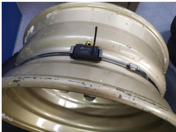
**!!!ВНИМАНИЕ!!! При монтаже шины на диск с установленным КМ, проводите работы таким образом, чтобы избежать контакта шины с КМ, что может привести к повреждению антенны и ее перелом в ходе эксплуатации под воздействием центробежной силы. Данное повреждение не является гарантийным случаем.**
